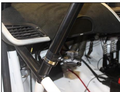
Hier ist die 25mm Gummikugelhalterung sicher an der A-Säulenleiste des Überrollkäfigs befestigt.
