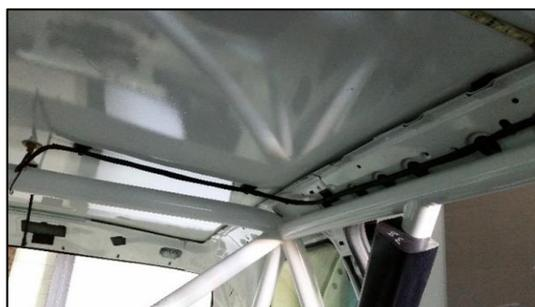
Die Antenne wird durch ein 12 mm großes Loch in der Mitte des Fahrzeugdaches befestigt, bevorzugt 50 mm entfernt vom Hauptbügel, um das Antennenkabel durch das Dach zu führen können und entlang des Überrollkäfigs bis zur RallySafe-Einheit zu befestigen.
