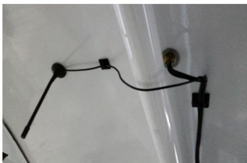
Hier ist die Antenne an der Innenseite von das Dach (bevorzugt)
